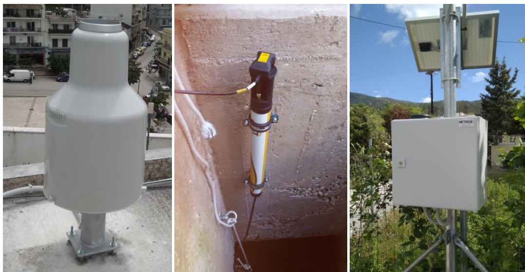
Εικόνα 3. Άποψη του βροχομετρικού σταθμού, του αισθητήρα μέτρησης της στάθμης των υπογείων υδάτων και του τηλεμετρικού σταθμού των ομβρίων υδάτων.
