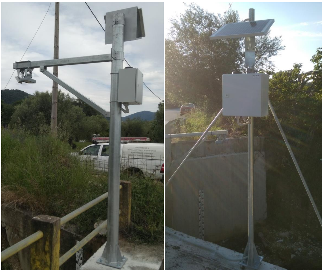
Εικόνα 2. Τηλεμετρικός σταθμός καταγραφής της στάθμης και της παροχής στο ρέμα Νέας Σελεύκειας – Μαυρουδίου και στο ρέμα Τσιμπουρίκι
