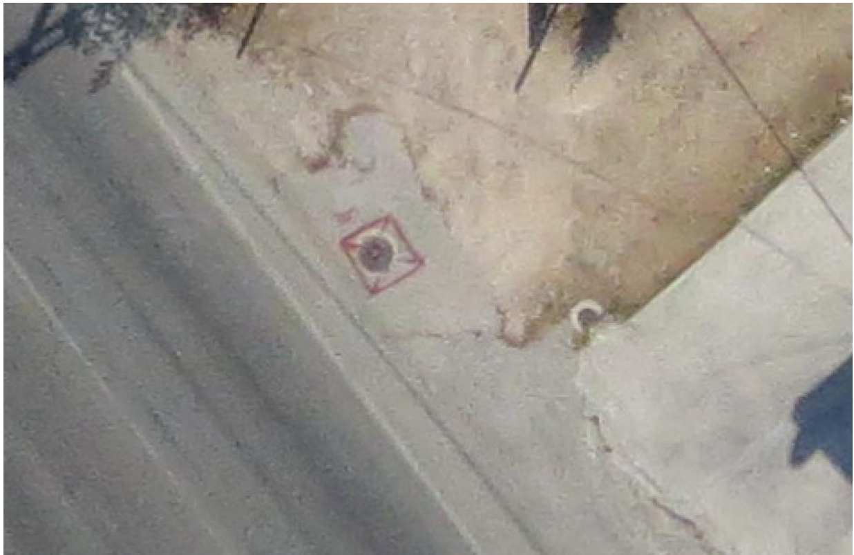
Φωτοσταθερά πλησίον του ρέματος Τσιμπουρίκι
