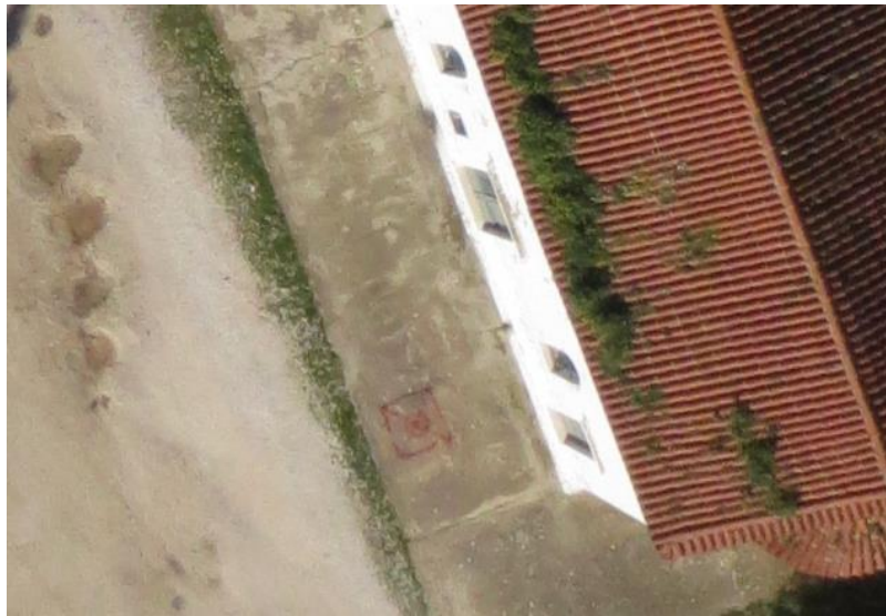
Φωτοσταθερά πλησίον του ρέματος Νέας Σελεύκειας – Μαυρουδίου
